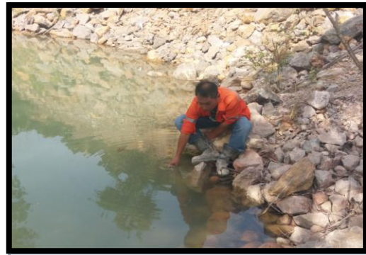
รูปที่ 2-9 การเก็บตัวอย่างน้ำบ่อดักตะกอน
