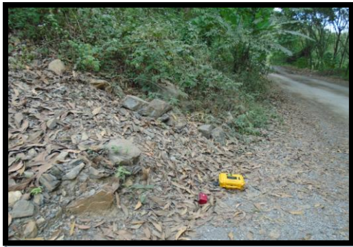
รูปที่ 2-8 การตรวจวัดความสั่นสะเทือนขอบประทานบัตร
