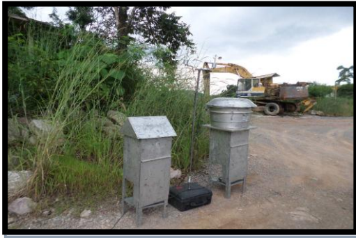
รูปที่ 2-3 การตรวจวัดคุณภาพอากาศ เสียง และความเร็วทิศทางลมบริเวณพื้นที่โครงการ
